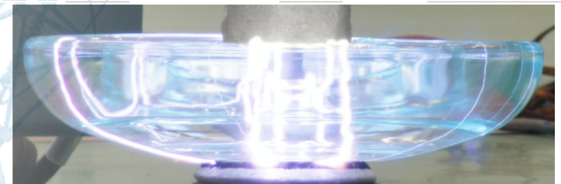
Detalhe do Ensaio de Perfuração sob frente de onda íngreme. Detalle del Ensayo de Perforación bajo impulso con frente de onda escarpado
