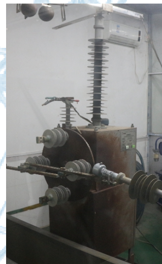
ENSAIO DE RODA DE TRILHAMENTO: UM DOS MAIS SEVEROS TESTES PARA ISOLADORES COMPOSTOS Teste de Rueda de trilhamento y erosión: Mientras os mas severos para aisladores compuestos
