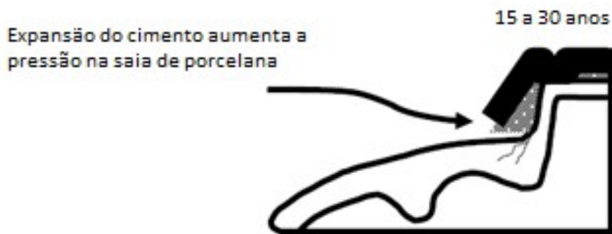
Figura 1 - Corte lateral de um isolador de disco de porcelana com problemas de expansão de cimento. A idade do isolador é de 15 a 30 anos. [3]
