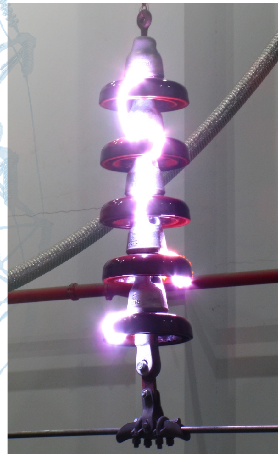
Detalhe do Ensaio de Tensão Disruptiva em Cadeia Reduzida. Detalle del Ensaio de Tensión de Flameo à Frecuencia Industrial en Cadena Reduzida.
